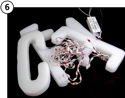
Die fertigen Frästeile mit LEDs und Transformator
