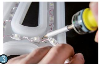
In den meisten kleinen Buchstaben ist für Verbindungsmittel kein Platz. Außerdem stört jeder Fremdkörper das spätere Lichtbild. Löten ist da die beste Verbindungsmöglichkeit. Die Isolation wird einfach an einer sinnvollen Stelle mit einem Skalpell entfernt. Mit einer dünnen Lötspitze werden die entsprechenden Kabel verbunden.
